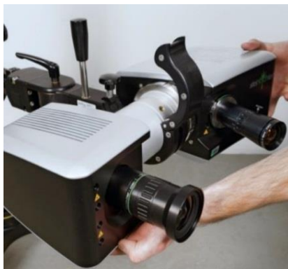
Рис. 5.26. Установка датчика СОМЕТА 6 в трёх координатную головку
