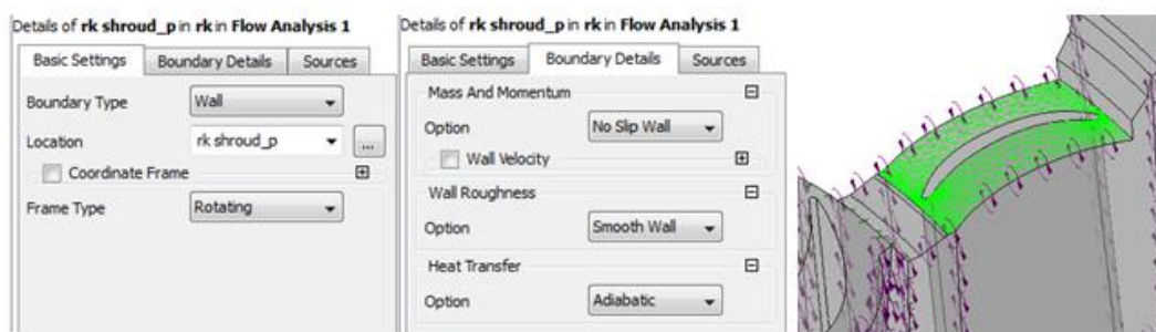
Рис. 2.36. Меню граничного условия непроницаемой стенки на поверхностях периферийного обвода рабочего колеса
