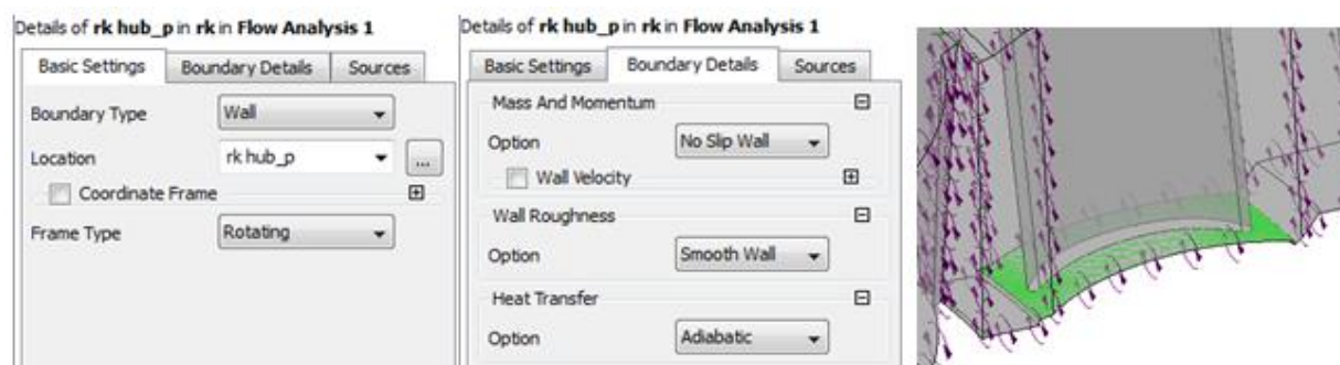
Рис. 2.35 Меню граничного условия непроницаемой стенки на поверхностях втулочного обвода рабочего колеса
