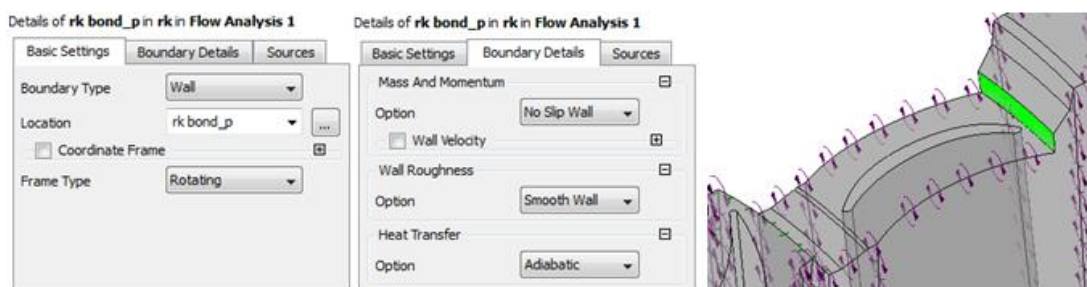
Рис. 2.38. Меню граничного условия непроницаемой стенки на поверхности бандажа рабочего колеса
