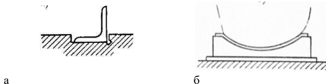
Рис. 2.8. Установочные постели и ложементы: а – опорное гнездо; б – ложементы
