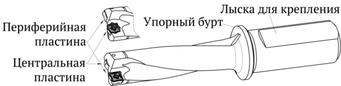
Рис. 5.1. Сборное сверло с СМП
