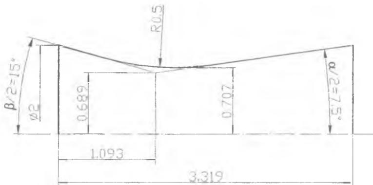
Рис. ЛЗ.1. Сечение сопла
