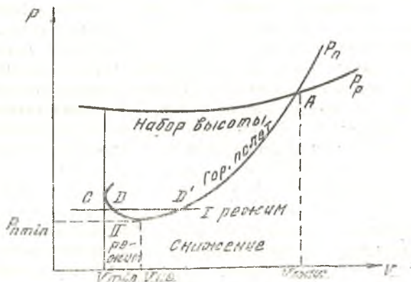
Рис. 2.10. Характерные области и режимы на диаграмме потребных и располагаемых тяг
