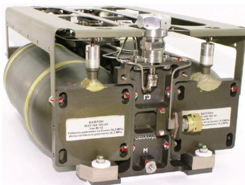
Рис. 1.18. Внешний вид блока хранения ксенона ЭРДУ КА «Канопус-В» [37]
