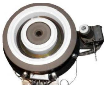
Рис. 1.9. СПД-140 разработки ОКБ «Факел»
