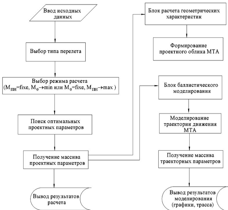
Рис. 8.1. Блок-схема алгоритма работы специализированного проектного комплекса
