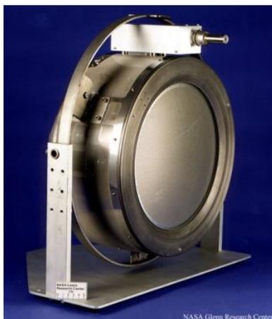
Рис. 1.7. Общий вид ионного двигателя NSTAR
