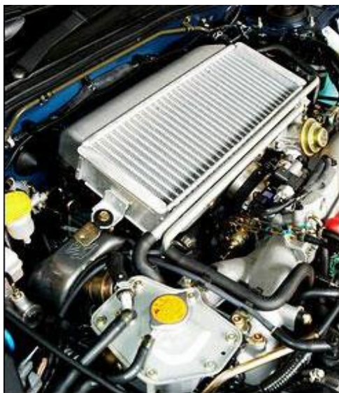
Рис. 10. Интеркулер (промежуточный охладитель наддувочного воздуха) в подкапотном пространстве двигателя
