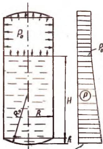
Рис. I.16. Бак с пологим сферическим днищем
