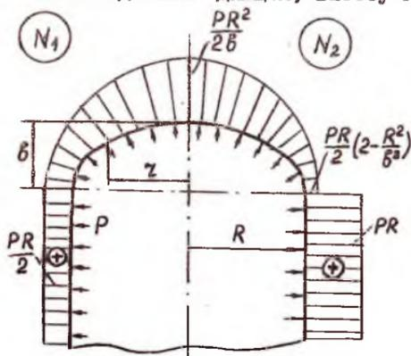
(рис. I.2). С точки зрения компоновки это днище более выгодно, чем полусферическое.
