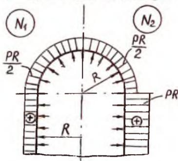
Рис. I.1. Полусферическое днище
