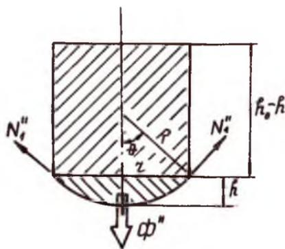
Рис. I.26. Сегмент сферического бака
