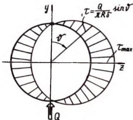
Рис. I.20. Касательные напряжения в поперечном сечении бака
