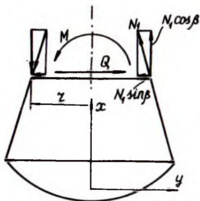
Рис. I.22. Отсеченная часть конического бака
