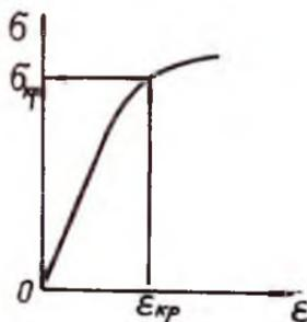
Рис. 2.15. К определению критических напряжений
