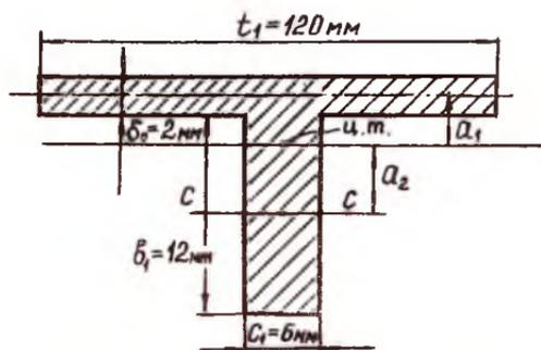
Рис. 2.16. Поперечное сечение вафельного цилиндрического бака
