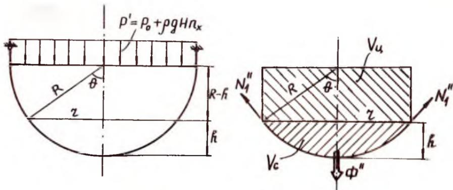
Рис. I.14. К расчету нижнего полусферического днища
