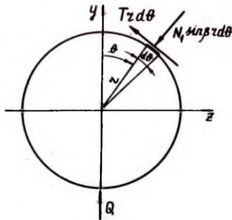
Рис. I.23. К уравновешиванию перерезывающей силы в поперечном сечении конического бака
