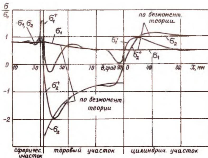
Рис. 1.32. Распределение напряжений в баке с торосферическим днищем
