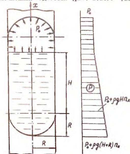
Рис. 1.13. Бак с полусферическими днищами и эпюра распределения давления
