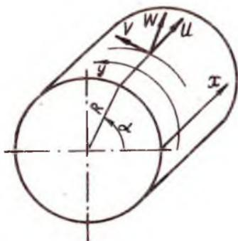
Рис. 2.1. Цилиндрическая оболочка
