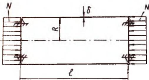
Рис. 2.3. Цилиндрическая оболочка при равномерном осевом сжатии
