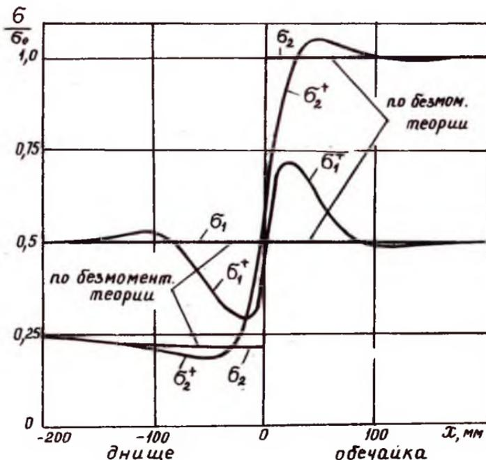
Рис. 1.31. Распределение напряжений вблизи стыка эллипсоидального днища ( $b/R = 0,8$ ) с цилиндрической обечайкой
