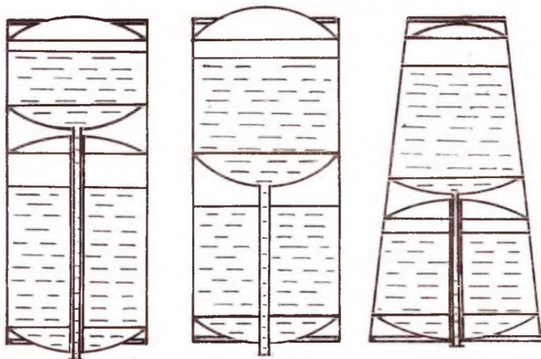
Рис. 1. Несущие топливные баки
