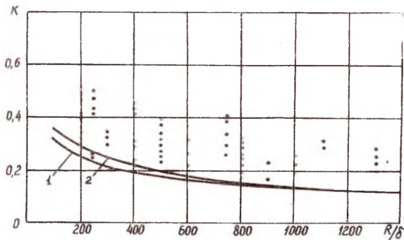
Рис. 2.4. Коэффициент устойчивости для цилиндрической оболочки при осевом сжатии
