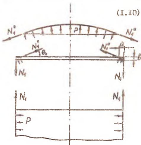
Рис. I.5. Усилия взаимодействия между элементами дна
