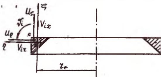
Обозначив через  $V_{ix}$ ,  $V_{iz}$  осевое и радиальное перемещение центра тяжести поперечного сечения кольца, а через  $\vartheta_i$  - угол поворота его сечения, можно ввести матрицу узловых перемещений  $i$ -ого узла в виде
