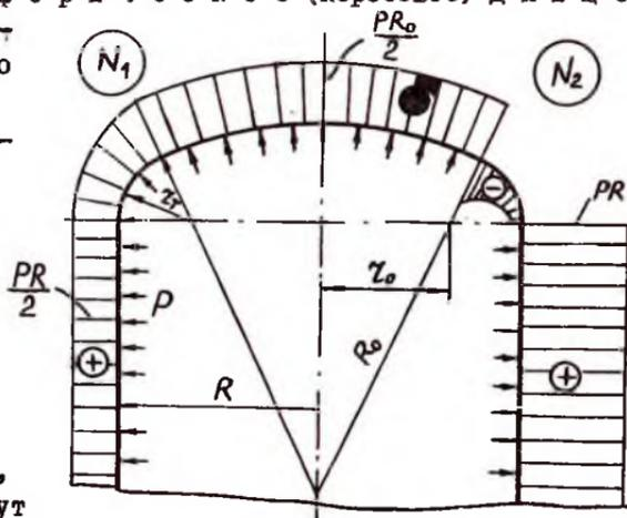
Рис. I.3. Торосферическое днище
