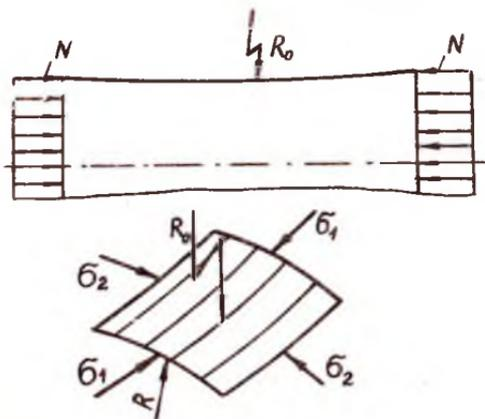
Рис. 2.9. Сжимаемая цилиндрическая оболочка с начальными несовершенствами
