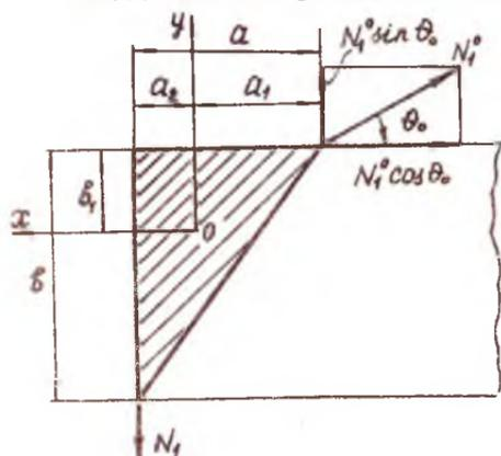
та  $m$  в поперечном сечении шпангоута возникает осевое усилие  $N = -qR$  и изгибающий момент  $M = mR$ . Зная эти величины, можно вычислить нормальные напряжения в поперечном сечении шпангоута по формуле
