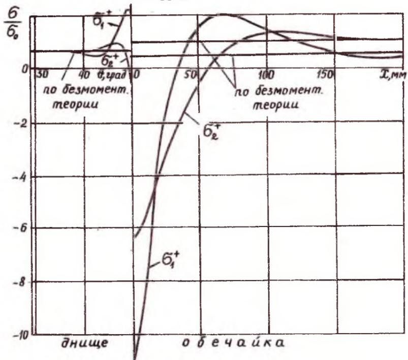
Рис. I.33. Распределение напряжений вблизи стыка пологого сферического дна с цилиндрической обечайкой
