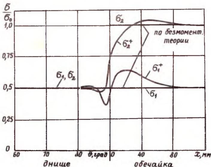
Рис. 1.30. Распределение напряжений вблизи стыка полусферического днища с цилиндрической обечайкой
