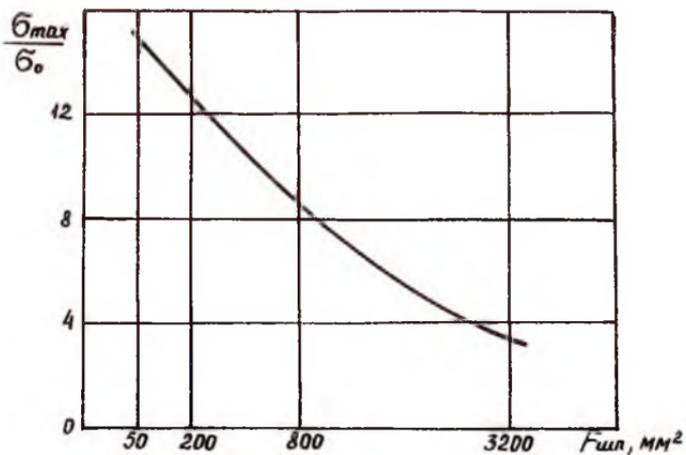
Рис. I.34. Зависимость максимальных напряжений в обечайке бака от жесткости распорного шпангоута
