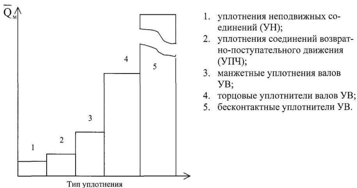
Рис. 2.11 Математическое ожидание утечек в зависимости от типа уплотнения
