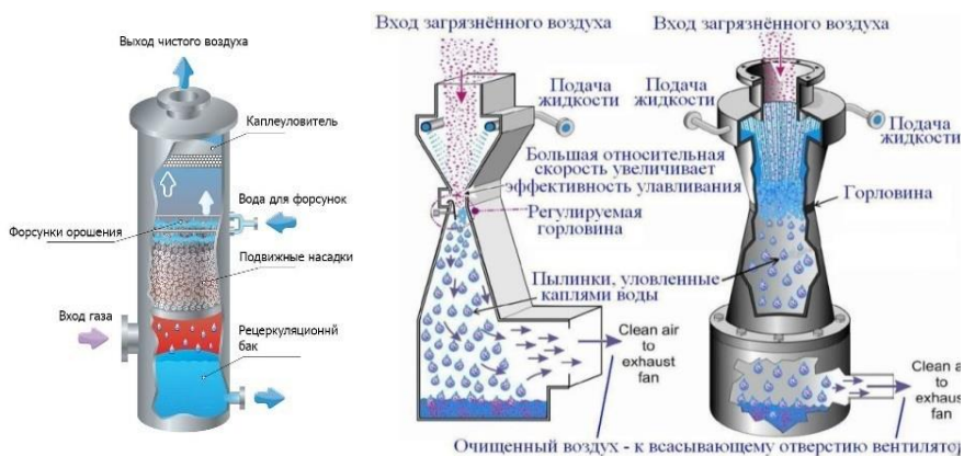
Рисунок 16 – Форсуночный скруббер и скруббер Вентури
