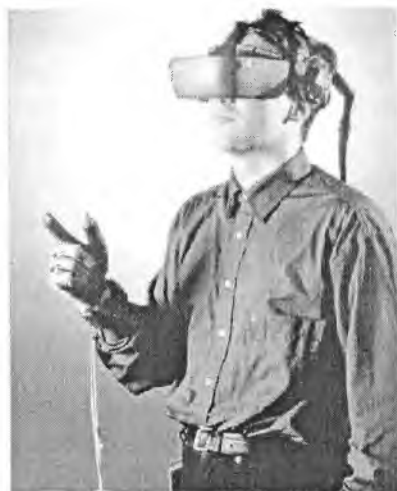
Рисунок 5-2 – Компоненты для интерактивного взаимодействия человека и машины в виртуальной реальности: специальные перчатки и шлем
