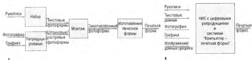
Рисунок 2-8 – Эволюция допечатных процессов путем оцифровывания сегментов обработки: а обычные допечатные процессы (1980); б цифровые допечатные процессы (1997)
