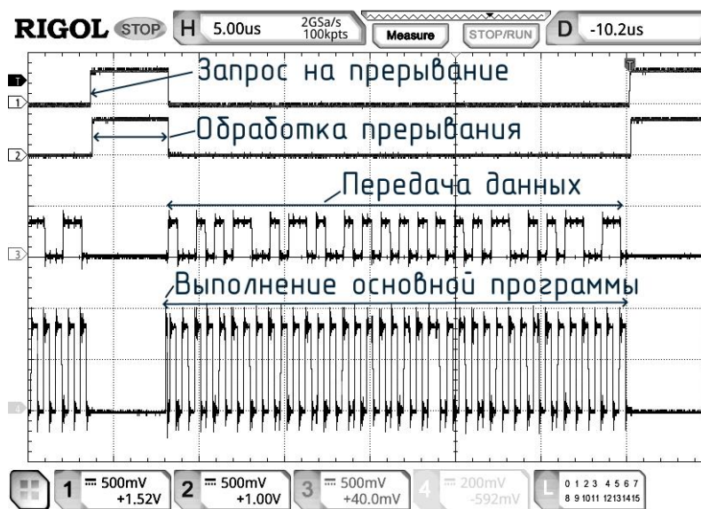
Рисунок 6.15 – Осциллограммы исполнения тестовой программы из табл. 7
