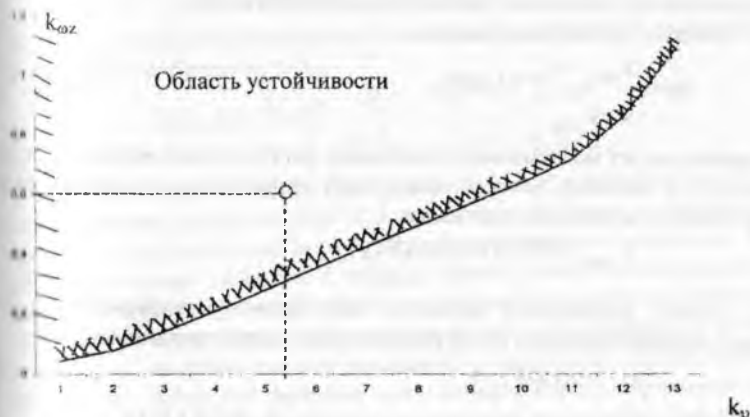
Рис. 3.21. Область устойчивости в плоскости параметров k_v и k_{\omega z}
