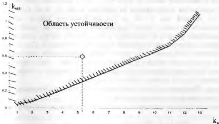
Рис.3.19. Область устойчивости системы стабилизации угла тангажа
