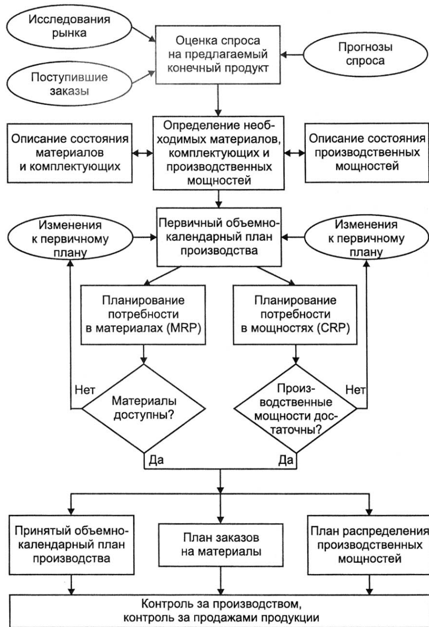
Рис. 1.4. Схема функционирования информационной системы, построенной на основе методологии MRP II
