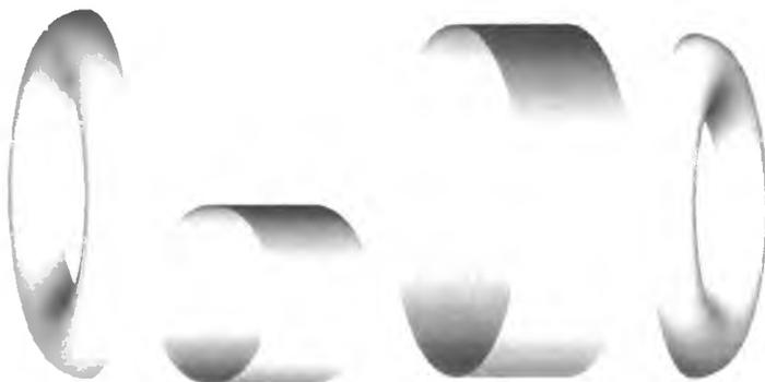
Рис. 15.4. Основные детали для сборки кольцевого бака
