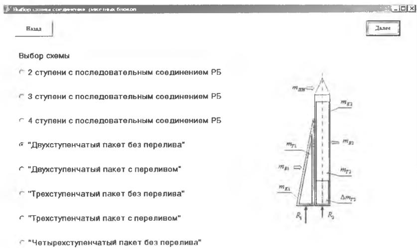
Рис. 14.2. Окно программы для выбора схем соединения ракетных блоков
