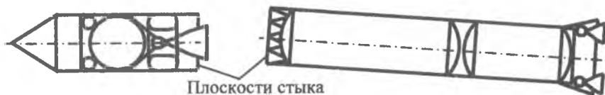
Рис. 11.14. Схема разделения РБ с переходной фермой
