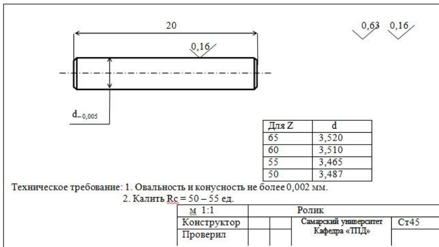
Рис. 2.47. Чертеж ролика
