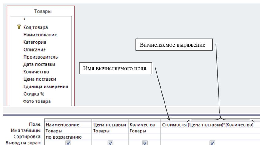
Рисунок 14 – Запрос с вычисляемым полем
