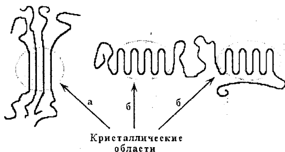
а) фибриллярная структура; б) складчатая структура.
