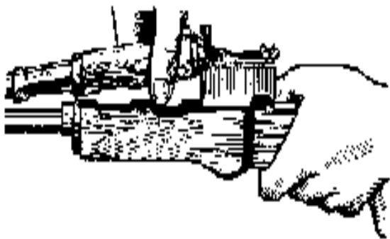
Рис. 36. Поворот замыкателя газовой трубки с помощью пенала принадлежности
