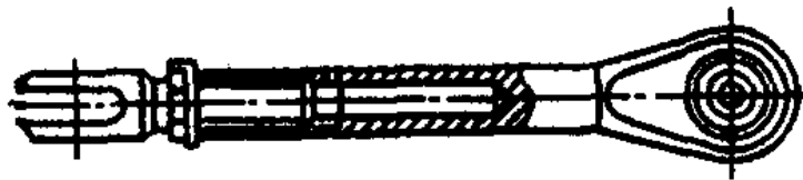
Рисунок 2.11 - Короткая регулируемая тяга из двух частей - тяги и наконечника
