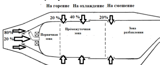
Рисунок 3.2 – Распределение воздуха в камере сгорания традиционного типа
