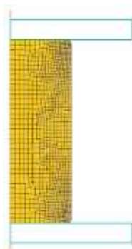
Рисунок 2.18. Расположение заготовки и бойков на начальном этапе осадки
