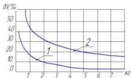
Рисунок 6.37 - Потери металла на заусенцы в зависимости от массы поковок простой (1) и сложной (2) форм
