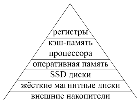
Рис. 1.6. Структура памяти ЭВМ
