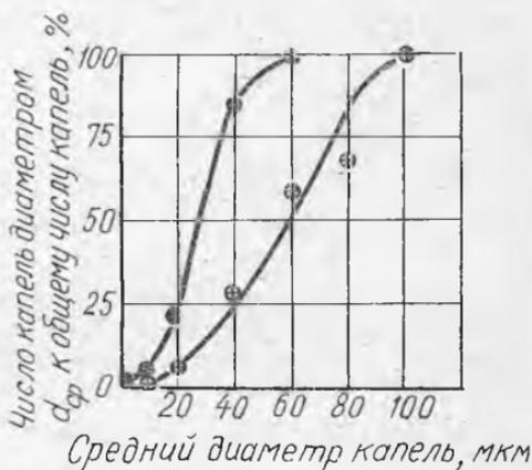
Рис. 4. Кривые распределения капель по размерам: ● — при наличии пульсаций; ⊕ — без пульсаций,  $\Delta P_{в} = 100$  кПа (1 атм);  $G_{в} = 1,2$  г/с;  $\Delta P_{ж} = 20$  кПа (0,2 атм);  $G_{ж} = 1,86$  г/с
