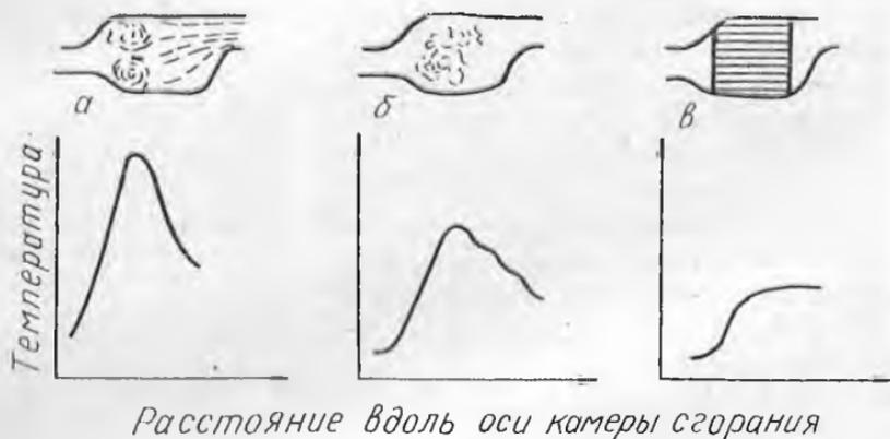
Рис. 37. Изменение температуры по длине камеры: а — обычная камера; б — камера со ступенчатым подводом тепла; в — каталитическая камера
