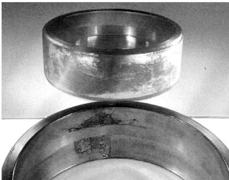
Рисунок 5 – Усталостная раковина на дорожке качения наружного кольца сферического роликоподшипника
