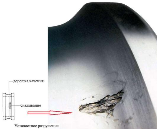
Рисунок 6 – Усталостное скалывание на поверхности внутреннего кольца шарикоподшипника
