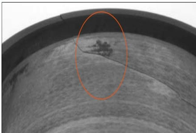
Рисунок 18 – Усталостное разрушение кольца подшипника из-за попадания посторонних предметов в дорожку качения
