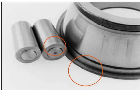
Рисунок 14 – Абразивный износ роликов и буртика кольца
