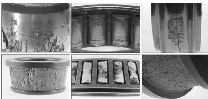
Рисунок 13 – Разрушение деталей роликоподшипника под действием избыточного натяга при маленькой скорости вращения
