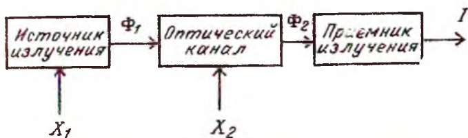
Рис. 2.1. Структурная схема оптических преобразователей перемещений
