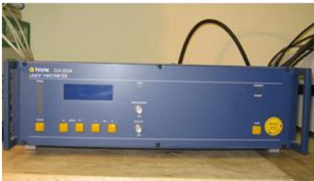
Рис. 4. Внешний вид бесконтактной системы измерения колебаний POLYTEC
