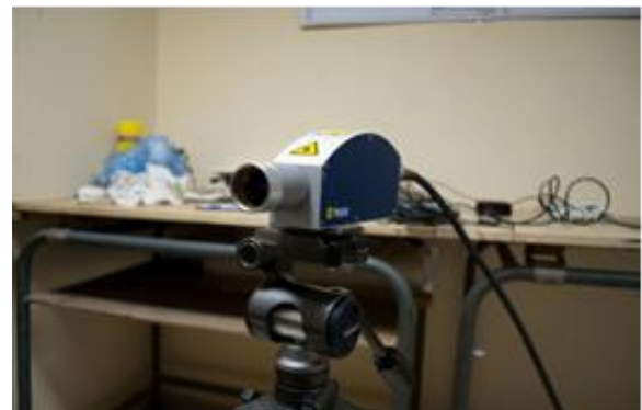
Рис. 4. Внешний вид бесконтактной системы измерения колебаний POLYTEC
