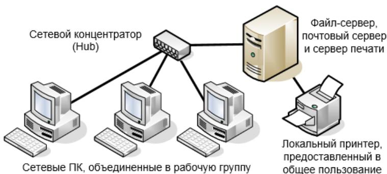
Рис. 1.29. Схема стенда при проведении инвентаризации состава ЛВС
