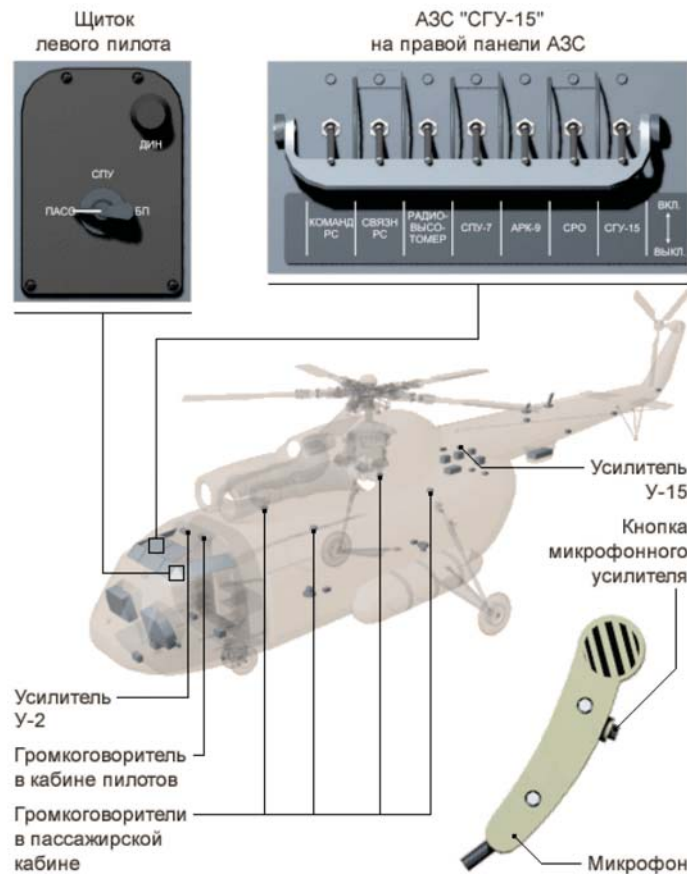
Рис. 3.10. Размещение и питание громкоговорящего устройства СГУ-15
