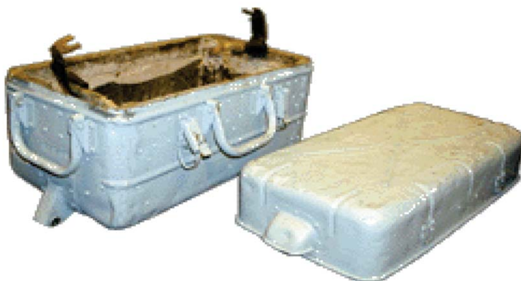
Рисунок 1.20. Контейнер аккумуляторной батареи
