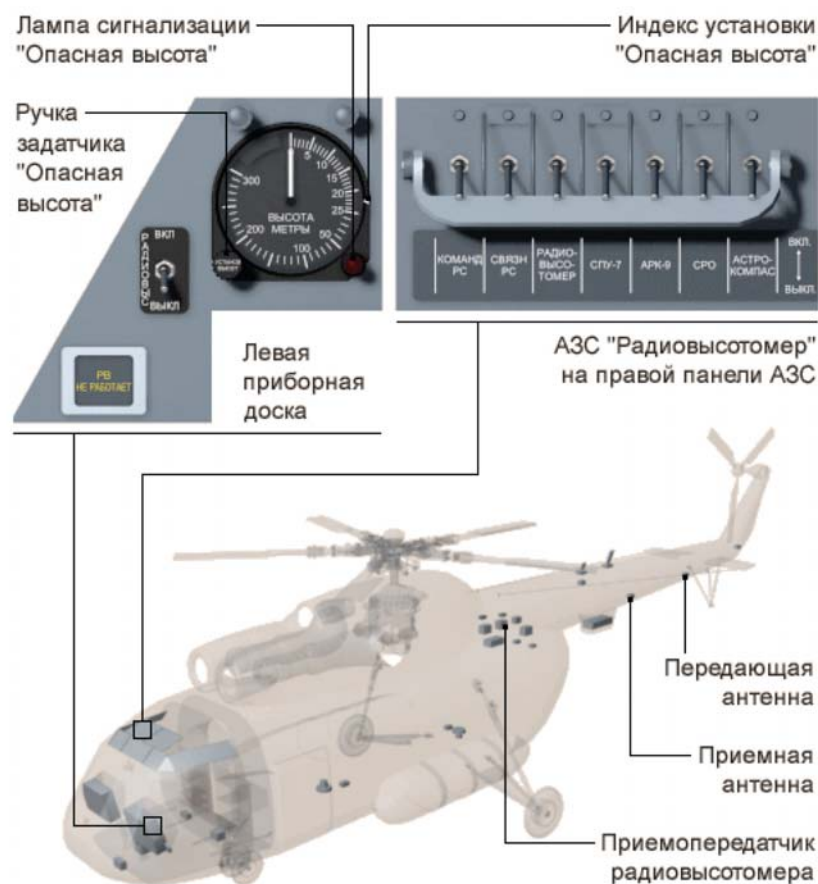
Рисунок 3.32. Размещение, защита и управление радиовысотомера РВ-3 на вертолете
