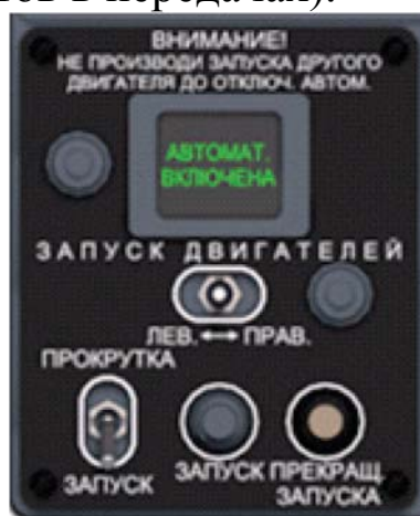
Рисунок 1.73. Электрощиток запуска двигателей
