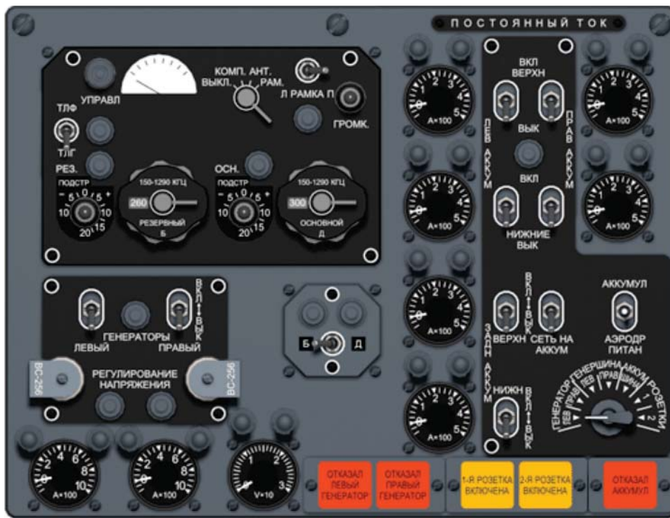
Рисунок 1.29. Панель электропульты постоянного тока:
