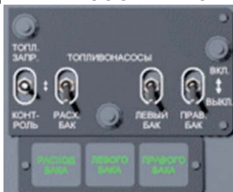
Рисунок 1.80. Управление и сигнализация топливных насосов
