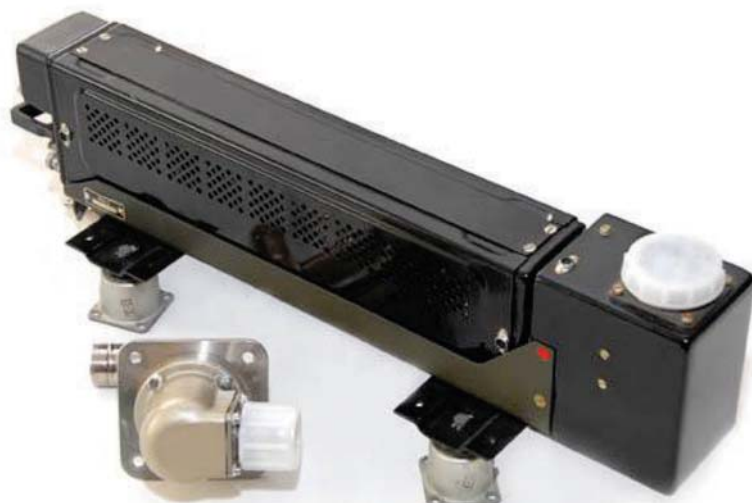
Рисунок 1.101. Общий вид электронного преобразователя сигнализации ПЭ-11М . сигнализатора СО-121ВМ на монтажной раме
