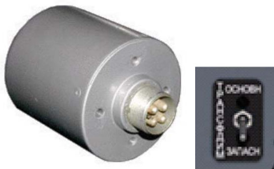
Рисунок 1.39. Трансформатор Тр-115/36 ДИМ и его переключатель
