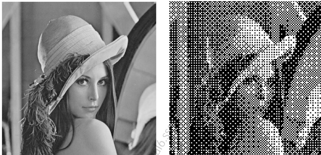
Рис. 1. Пример полутонного изображения и полученного из него растриванного бинарного изображения
