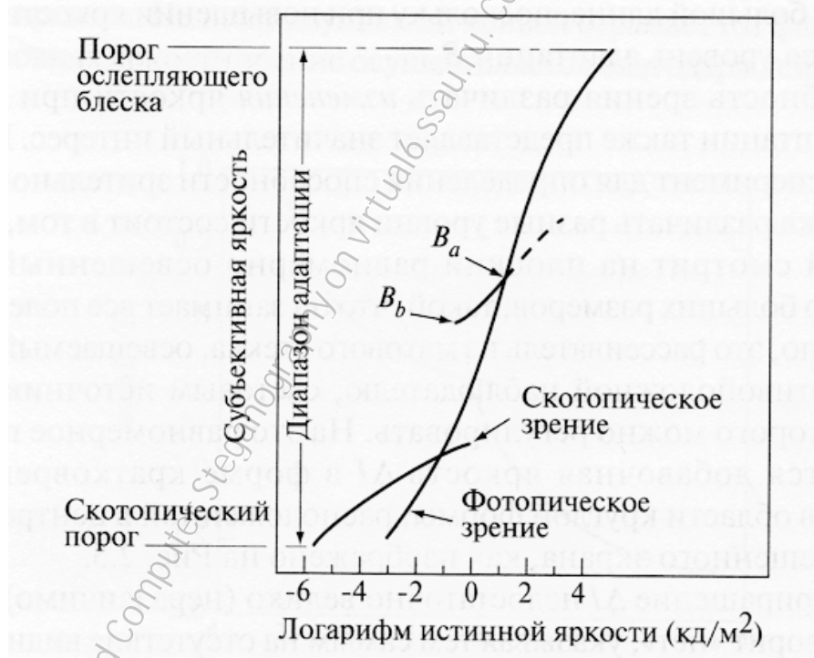
Рисунок 2.5 – Диапазон субъективно воспринимаемой яркости и конкретный уровень адаптации
