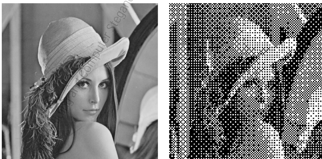
Рис. 1. Пример полутонового изображения и полученного из него растриванного бинарного изображения
