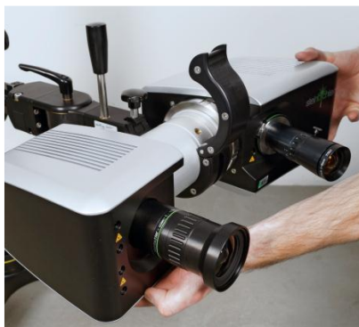
Рис. 4.18 – Установка датчика СОМЕТА 6 в трёхкоординатную головку
