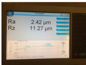
Рис. 3.20 Процесс измерения шероховатости поверхности
