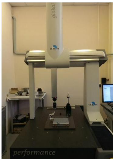
Рис. 4.1 – Процесс измерения детали на КИМ «DEA Global Performance 07.10.07»
