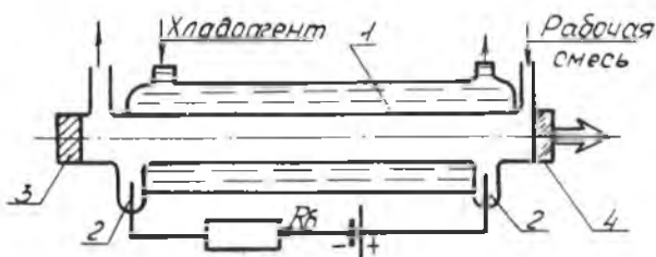
Рис. 5.3. Схема лазера с диффузионным охлаждением рабочей смеси: 1 — разрядная трубка; 2 — электрод; 3 — глухое зеркало; 4 — полупрозрачное зеркало
