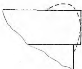
Рис. 25. Профиль пресс-шайбы: — до прессования, - - - после прессования
