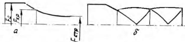
Рис. 3.4. Конфигурация струи за срезом сужающегося сопла при различных значениях  $\pi_{ср}^*$ : а—значение  $\pi_{ср}^* < \pi_{ср}^*$ ; б— $\pi_{ср}^* < \pi_{ср}^* < \pi_{ср}^*$
