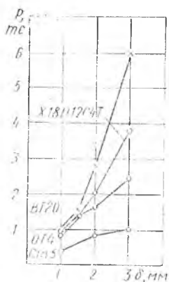
Рис. 4.2. Зависимость усилия обкатки от толщины материала d = 12 \text{ см} , C = 1,6 \text{ см}
