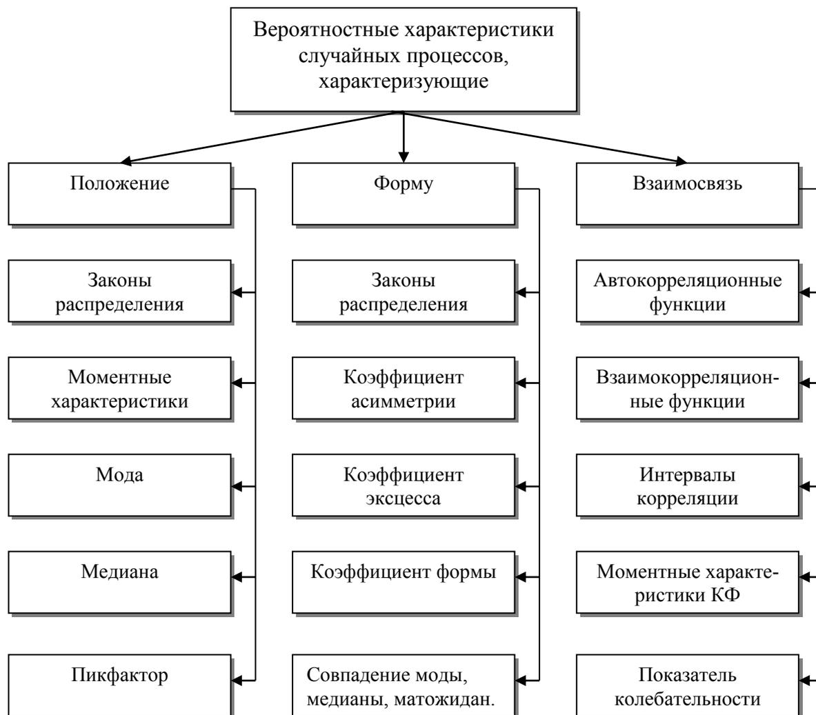
Рисунок 1.11- Классификация вероятностных характеристик случайных процессов
