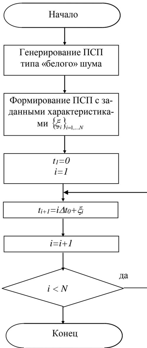
Рисунок 2.11 - Блок-схема моделирования регулярного потока с «дрожанием»
