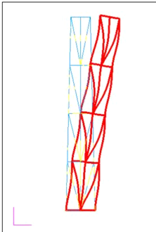
Рис. 3.3.15. Деформации фермы под нагрузками
