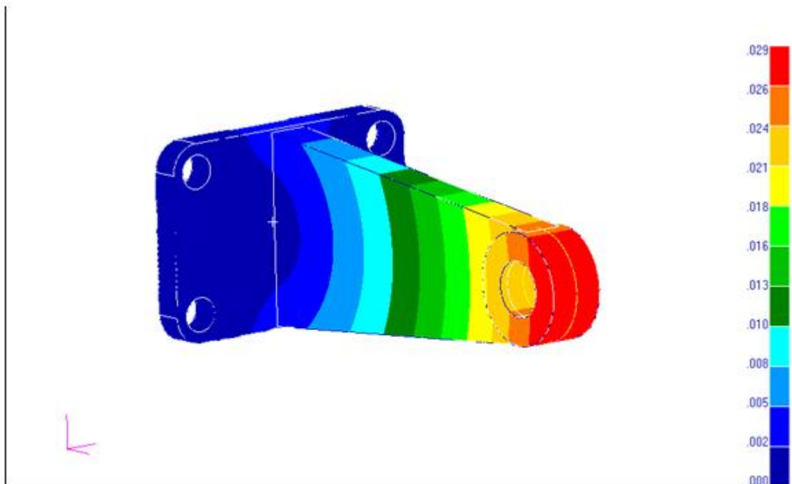
Рис. 3.2.18. Деформированное состояние кронштейна заливкой (Style - Discrete/Smooth)
