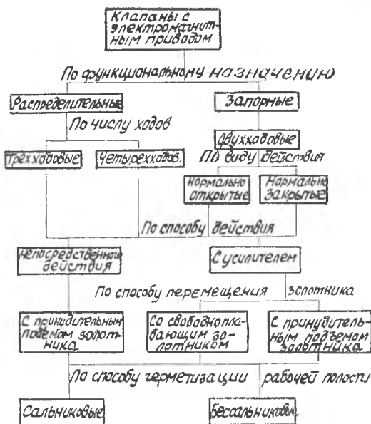
Рис. 2.14. Классификация клапанов с электромагнитным приводом
