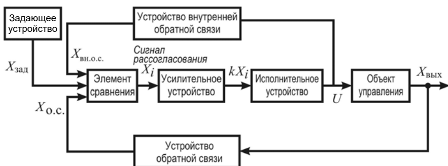
Рис. 1.3. Структурный состав системы автоматического регулирования
