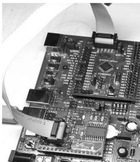
Рис. 3.11 – Соединение программатор CoLink ARM Cortex JTAG с микроконтроллером
