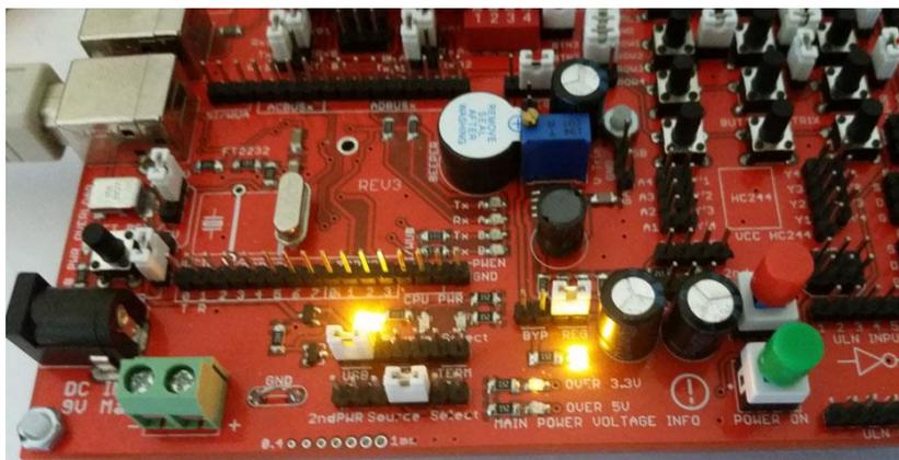
Рис. 3.40 – Индикация питания и превышения допустимых значений
