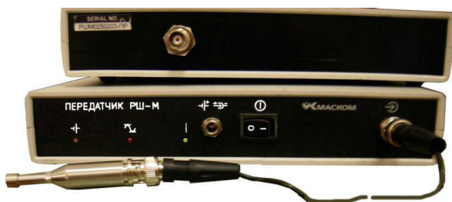
Рис. 16 – Внешний вид задней панели приемника (сверху) и передней панели передатчика с подключенным микрофоном
