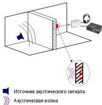
Рис. 4 – Виброакустический канал утечки информации
