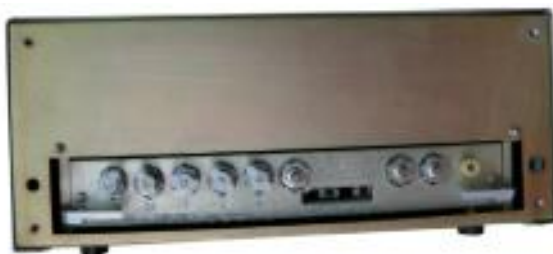
Рис. 8 – Передняя панель генератора «Шорох-2МИ» со снятой крышкой
