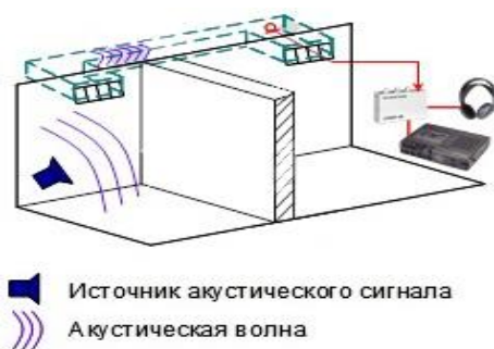
Рис. 3 – Акустический канал утечки информации
