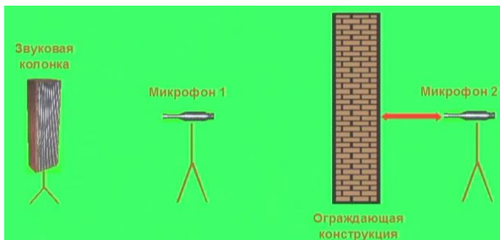
Рис. 55 – Положение второго микрофона относительно ограждающей конструкции
