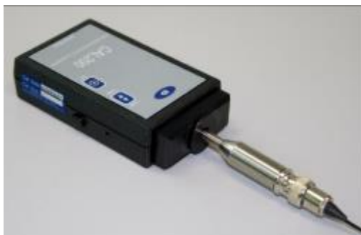
Рис. 18 – Внешний вид калибратора с подключенным микрофоном
