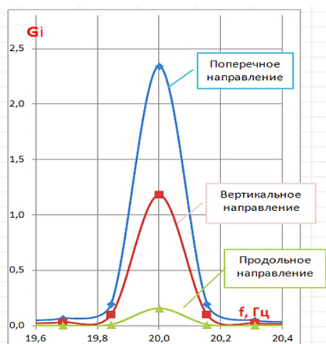
Рис. 3. Трёхмерная структура вектора вибрации блока двигателя, N=750 об/мин
