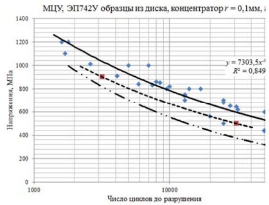
Рис. 5. Кривые МЦУ для материала ЭП742У, с концентратором r = 0,1\text{мм} , при t = 20^\circ\text{C}
