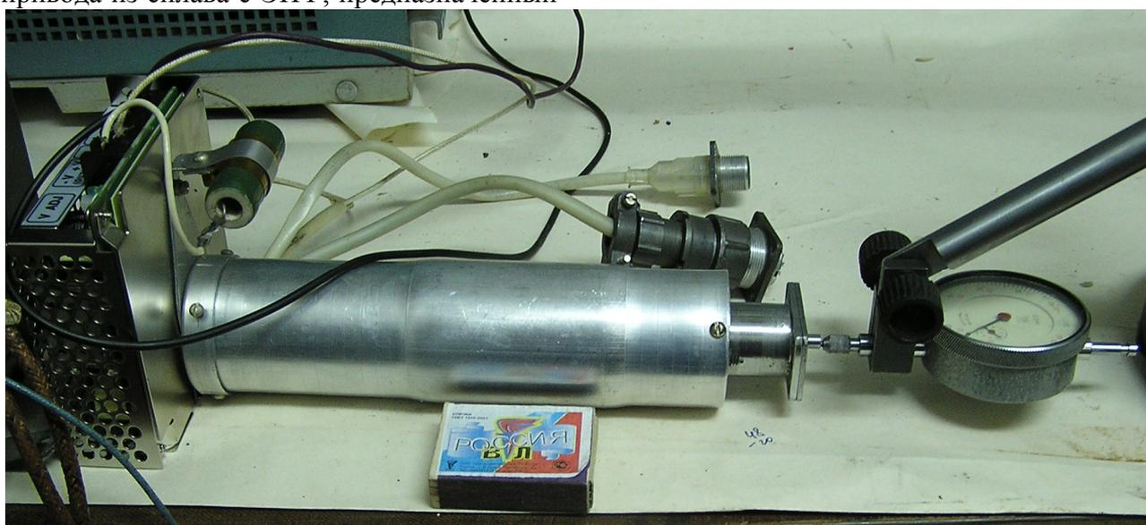
Рис. 1. Опытный образец силового привода из сплава с ЭПФ для узла расчеховки КА
