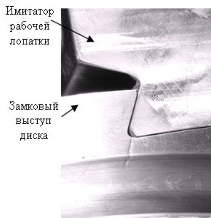
Рис. 1 Образование трещины в замке диска 1 ст. КНД при испытаниях на установке
