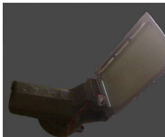
Рис. 2. Панель установленная на массивном основании с закреплённым вибровозбудителем
