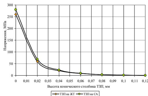
Рис. 2. Максимальные напряжения по высоте конических столбиков ТЗП толщиной 120 мкм
