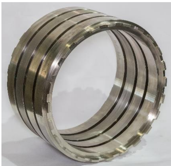
Рисунок 1 – сваренная секция ободов из ЭП741НП
