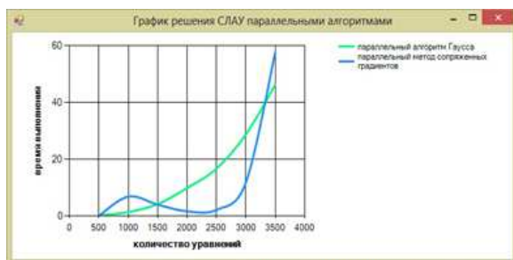
Рисунок 3 – График решения СЛАУ параллельными алгоритмами для задачи анализа входных воздействий на объект
